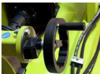
Regolazione della profondità Depth adjustment Einstellung der Tiefe Réglage de la profondeur Regulación de la profundidad
