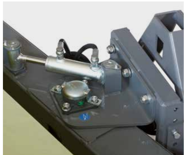
Inclinazione idraulica 25° dx-sx Hydraulic turn angle 25° left/right Hydraulische Winkelverstellung 25° links/rechts Inclination hydraulique droite et gauche 25°
