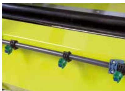
Gruppo umidificatore 130/260 Lt. Water sprayer unit 130/260 Lt. Wassersprüheinrichtung 130/260 Lt. Humidificateur 130/260 Lt.
