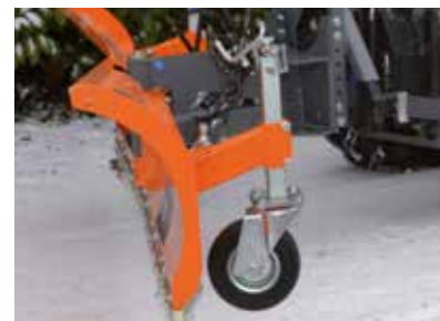
Ruote Ø 200x70 mm Wheels Ø 200x70 mm Räder Ø 200x70 mm Roues Ø 200x70 mm
