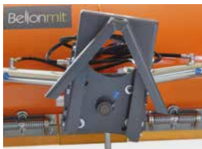
Attacco a triangolo Cat. 0-1 Triangle linkage Cat. 0 or 1 Kupplungsdreieck Kat. 0 oder 1 Attelage par triangle Cat. 0-1
