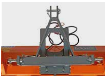
Attacco 3° punto Cat. 1-2 3-point linkage Cat. 1 or 2 3-Punkt Anbau Kat. 1 oder 2 Attelage à 3 points Cat. 1-2
