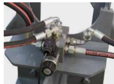
Elettrovalvola 12 V Electrovalve 12 V Elektroventil 12 V Electrovanne 12 V
